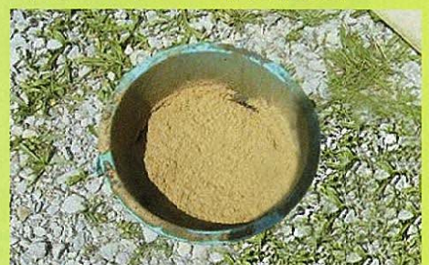
漏れた作動油をバケツに集め(5L)、オイルゲーターを約2kg使用し処理した。
